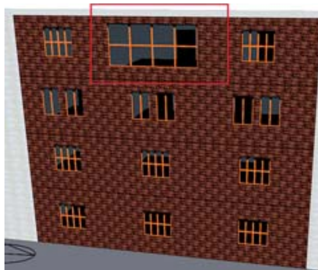
Fig. 4, 5 - Analisi parametriche sulla superficie finestrata di un'aula all'ultimo piano: variazione del rapporto tra superficie vetrata e superficie calpestabile da 1/8 a 1/3.
